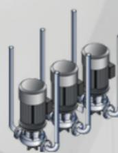
Fig. 1.2. 3 pompa in-line susunan paralel; akses maintenance terbatas karena sistem perpipaan
